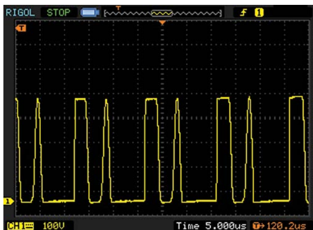
Рис. 8. Напряжение на стоке транзистора при среднем значении сетевого напряжения
