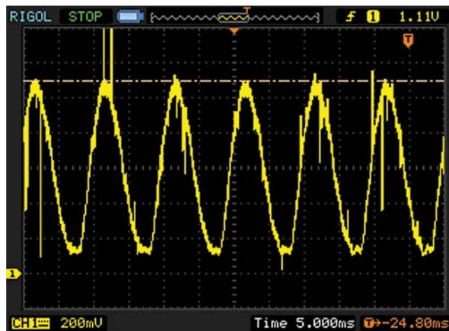
Рис. 4. Осциллограмма напряжения на входе LD
