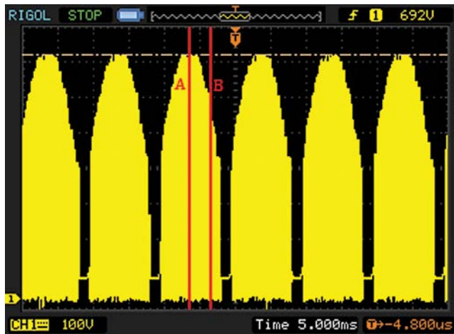
Рис. 6. Напряжение на стоке транзистора при работе ИП на нагрузку 40 Вт
