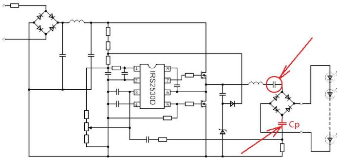
Рис. 5. Изменения в штатной схеме включения IRS2530 для развязки выходной цепи
